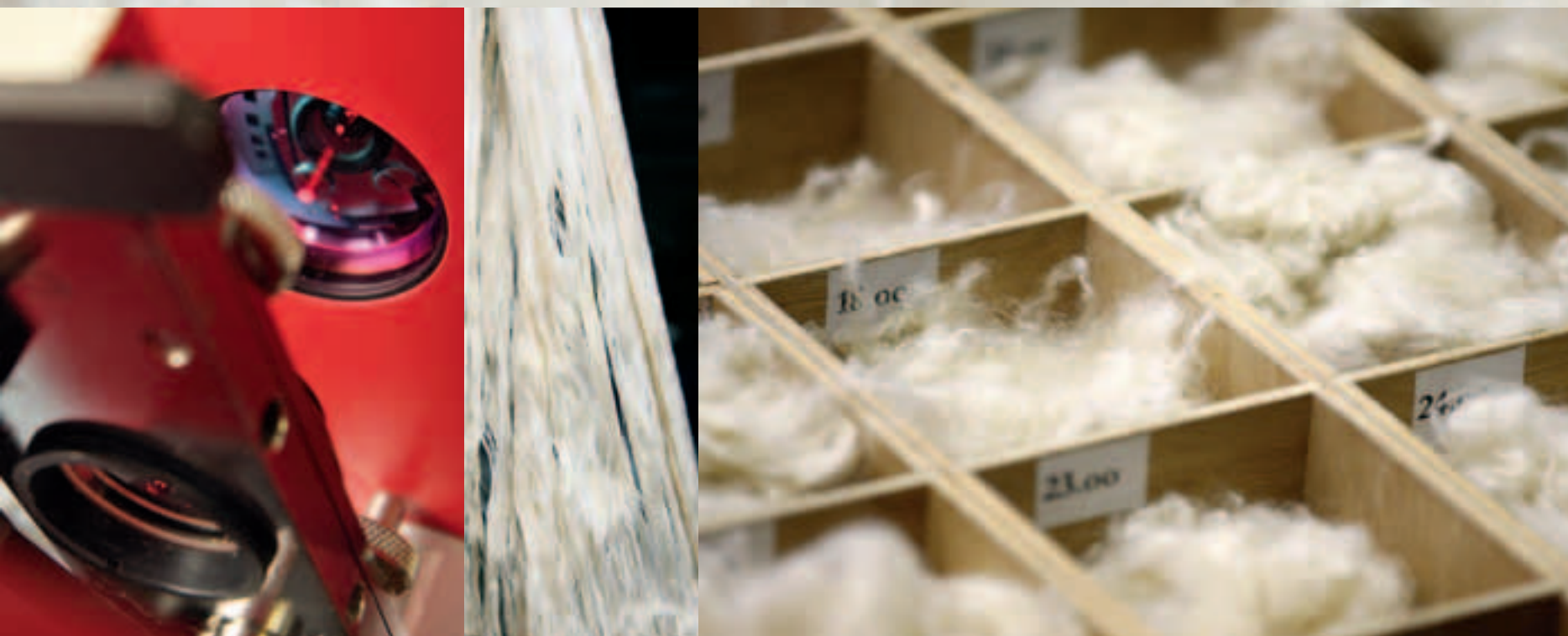
Links: Mit einem Laser-Messgerät wird die Qualität der Smartfiber-Fasern untersucht. Mitte: So kommen die Lyocell-Fasern aus der Maschine. Rechts: Die „smartcel clima“-Faser in einem Probenkasten des Smartfiber-Analyse-Labors. Textilien, die mit diesem „Phase Change Material“ hergestellt werden, können durch in die Faser integriertes Paraffin überschüssige Wärme vom Körper aufnehmen und bei Bedarf wieder abgeben.
